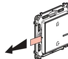
Retire a tira de proteção da pilha para alimentar o comando geral sem fios.
